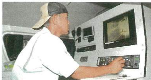
テレビ画面により配管内部を確認できる
