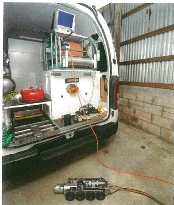
医療に例えるならば内視鏡のような役割を担う「配管内検査用カメラ」
